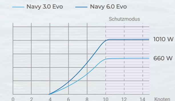
\* Die Rekuperationsdaten basieren auf realen Tests mit installierter Antiventilationsplatte.
